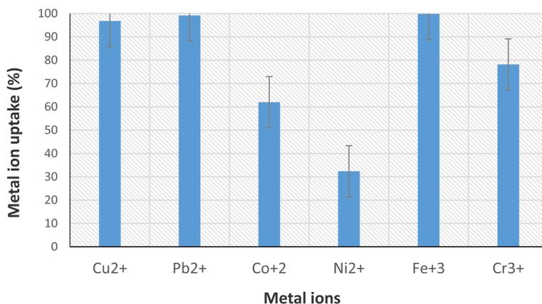
**Fig. 6** Effect of mixed heavy metal ions on Cu<sup>2+</sup> uptake (Cu<sup>2+</sup> conc. 80 ppm; Pb<sup>2+</sup>, Cr<sup>3+</sup>, Ni<sup>2+</sup>, Fe<sup>3+</sup>, or Co<sup>2+</sup>, 25 ppm)
